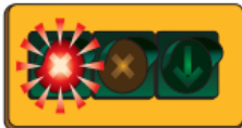
控制信号:置于车道上方，指示哪条车道可供驾驶。在这里: 红色=不要在右车道行驶
